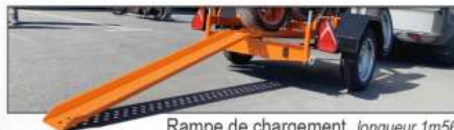
Rampe de chargement, longueur 1m56 Hauteur de chargement : 0m38
