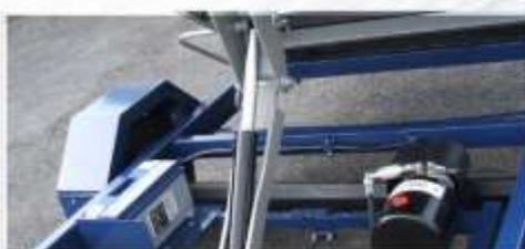
Bennage électrique avec batterie
