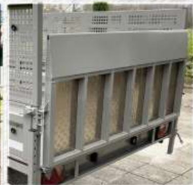
Rehausses + Porte pont
