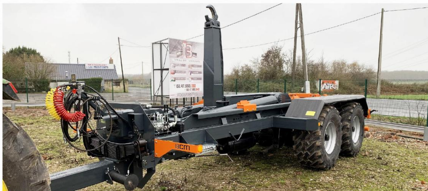
Bras reconditionné, RC 560*60 R22.5 FL693, Anneau boulonné, Prise hydraulique arrière avec coupleurs D.D.S.P. ...
