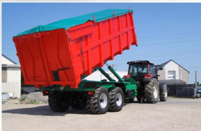
Bras reconditionné, Tandem 'Standard', suiveur 'Classique', Rallonge hydraulique avec prises DDSP
