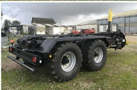
Bras reconditionné, RC 560*60 R22.5 FL630, Anneau tournant boulonné, Prise hydro. arrière avec coupleurs D.D.S.P. ...
