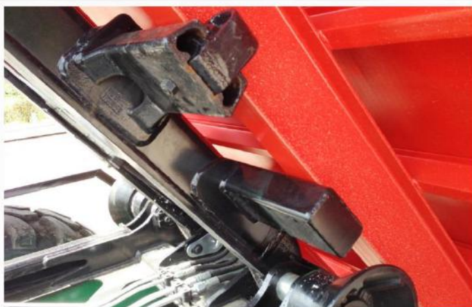
Bras NEUF HIAB, Tuyauterie rigide sur vérin de levage, support berce pour libération effort sur rouleau
