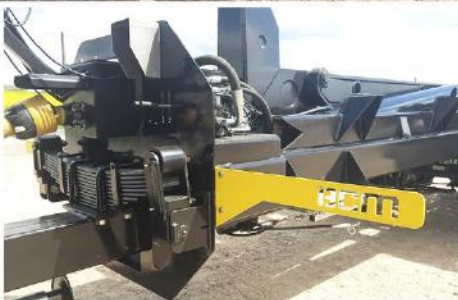
Bras reconditionné, suiveur 'Classique', RC 500*60 R22.5 FL630
