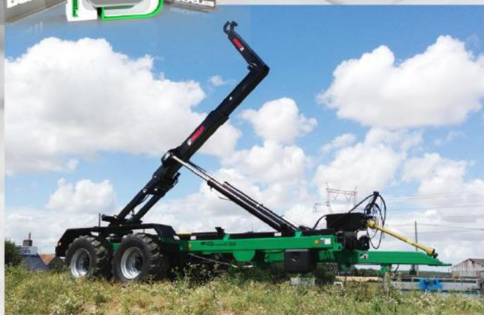
Bras NEUF HIAB, Tandem 'Surbaissé', RC 500/60 R22.5, groupe Pompe-Distributeur indépendant
