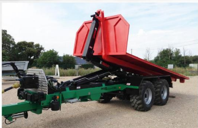
Bras NEUF HIAB, Tuyauterie rigide sur vérin de levage, support berce pour libération effort sur rouleau
