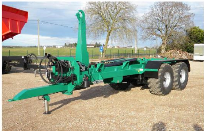
Bras reconditionné, suiveur 'AutoPiloté', RC 560/60 R22.5, Pompe à main sur béquille avant Sarl BCM - D910 La Normandie - 37110 VILLEDOMER - 02.47.550.100 - www.remorques-bcm.com
