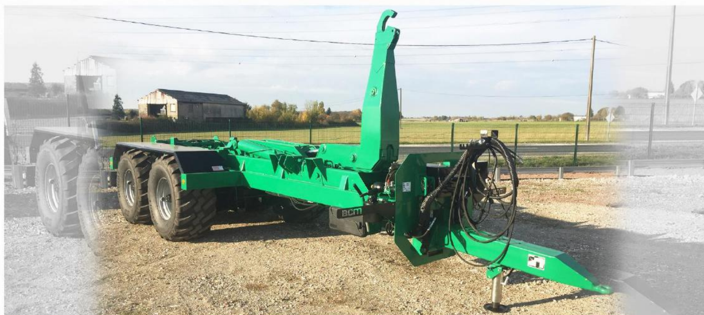
Bras reconditionné, RC 560*60 R22.5 FL693, Rallonge double effet Arr. avec coupleurs DDSP, Cardan Homocinétique...
