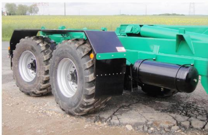
Bras reconditionné, Freinage Mixte 25km/h, suiveur 'Classique', RC 560/60 R22.5
