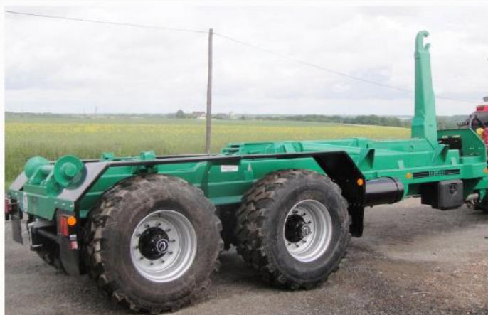
Bras reconditionné, Freinage Mixte 25km/h, suiveur 'Classique', RC 560/60 R22.5
