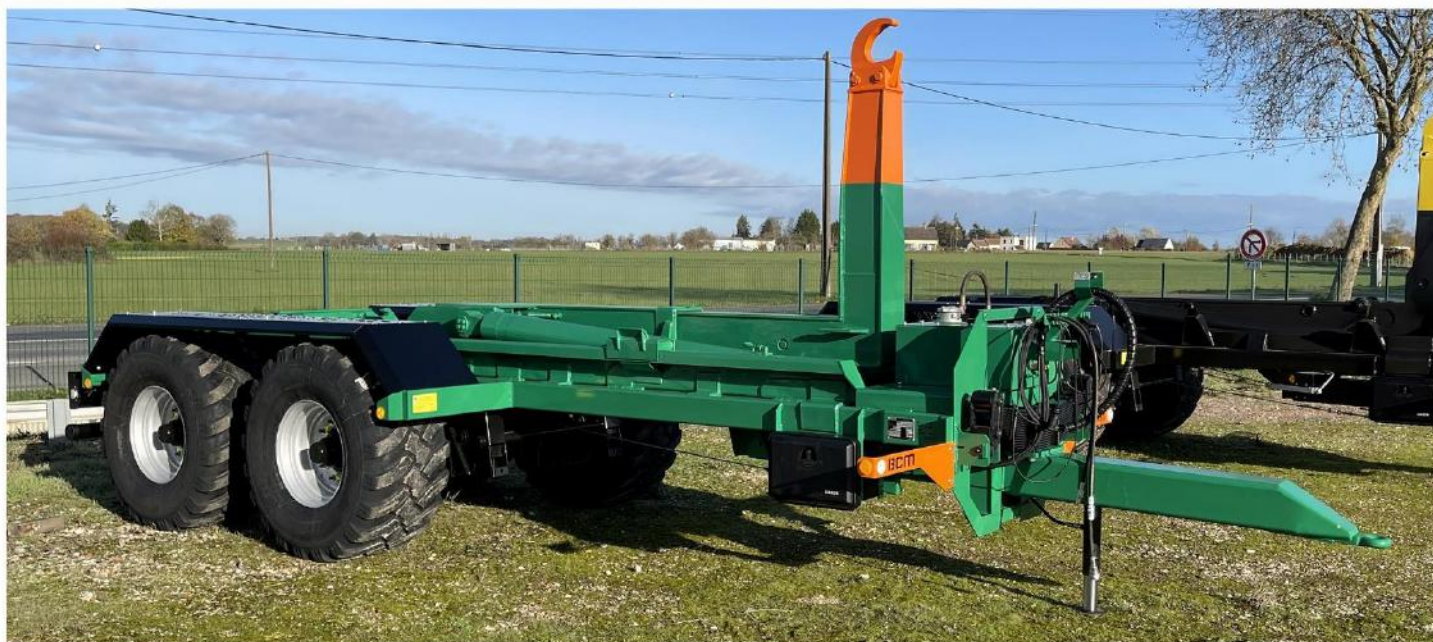
Bras reconditionné, RC 560*60 R22.5 FL630, Anneau tournant boulonné, Prise hydro. arrière avec coupleurs D.D.S.P. ...
