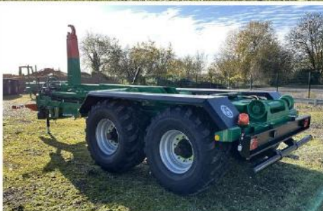
Bras recon., Freinage Mixte, RC 560*60 R22.5 FL630, Anneau fixe soudé, pompe à pistons 80L/min 350b... Sarl BCM - D910 La Normandie - 37110 VILLEDOMER - 02.47.550.100 - www.remorques-bcm.com
