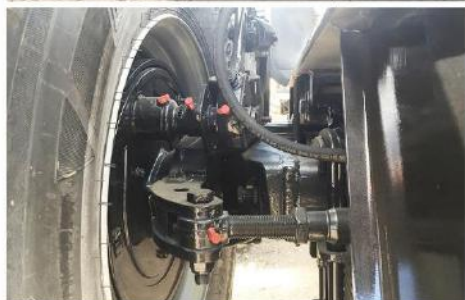
Bras reconditionné, suiveur 'Classique', RC 500*60 R22.5 FL630
