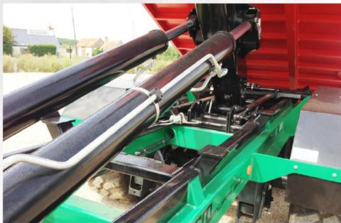
Bras NEUF HIAB, Tandem 'Surbaissé', RC 500/60 R22.5, groupe Pompe-Distributeur indépendant
