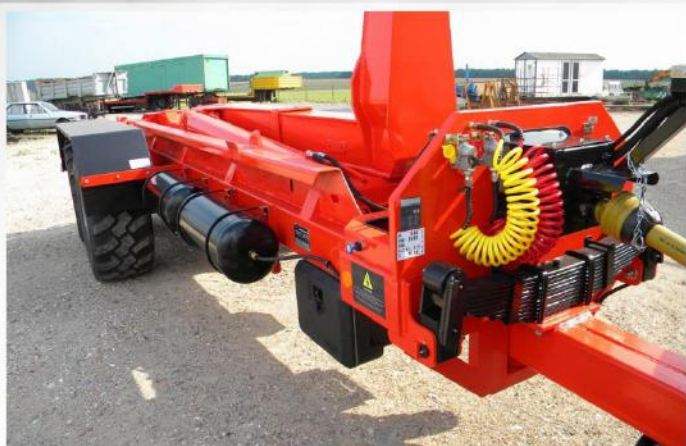
Bras reconditionné, Freinage AIR 40km/h, suiveur 'Classique', Anneau à boulonner
