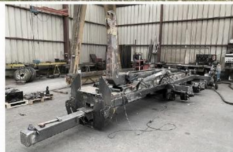
Bras reconditionné, RC 560*60 R22.5 FL630, Anneau tournant boulonné, Prise hydro. arrière avec coupleurs D.D.S.P. ...
