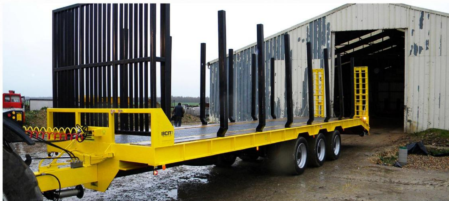
Dim. : 8m20 x 2m54, Tridem Colaert 40Km/h, Suiv. Av & Ar, RC 215/75 R17.5, Rampes régl. largeur , Elargisseurs...
