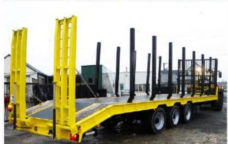
Dim. : 11m60 x 2m54, Tridem, Freinage mixte 25Km/h, Suiv. arr, RC 445/65 R22.5 + RS, Ranchers lat., Grille avant...
