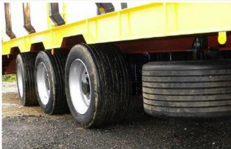
Dim. : 11m60 x 2m54, Tridem, Freinage mixte 25Km/h, Suiv. arr, RC 445/65 R22.5 + RS, Ranchers lat., Grille avant...
