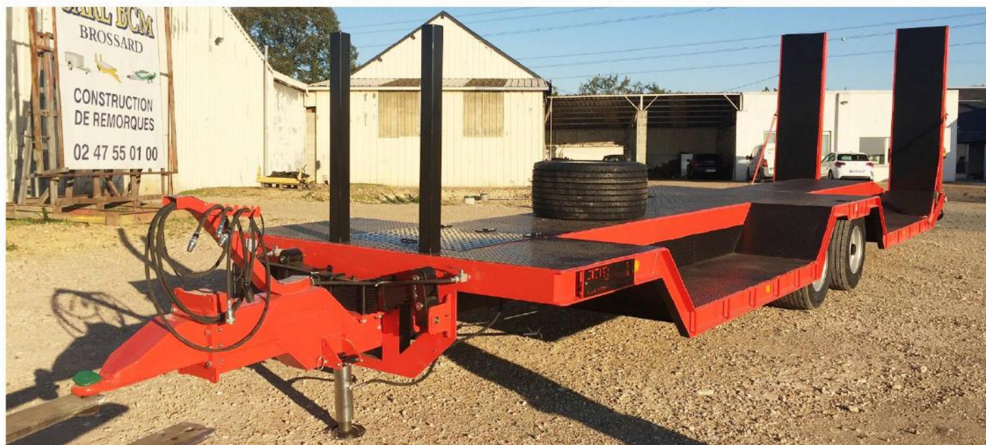
Surface utile : 10m00 x 2m54, RC 215/75 R17.5 Jum., Plate-forme Fosses et résa. sur châssis
