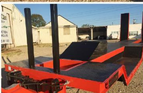
Surface utile : 10m50 x 2m54, RC 445/45 R19.5, Double ranchers av., Bég. arr. Hydro., Coffre central...
