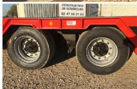
Surface utile : 10m50 x 2m54, RC 445/45 R19.5, Double ranchers av., Bég. arr. Hydro., Coffre central...
