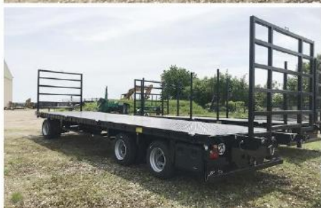
Surface utile : 9m00 x 2m54, Tourelle, RJ 215/75 R17.5, Echelle av/arr avec rallonge, Rampes Aluminium...
