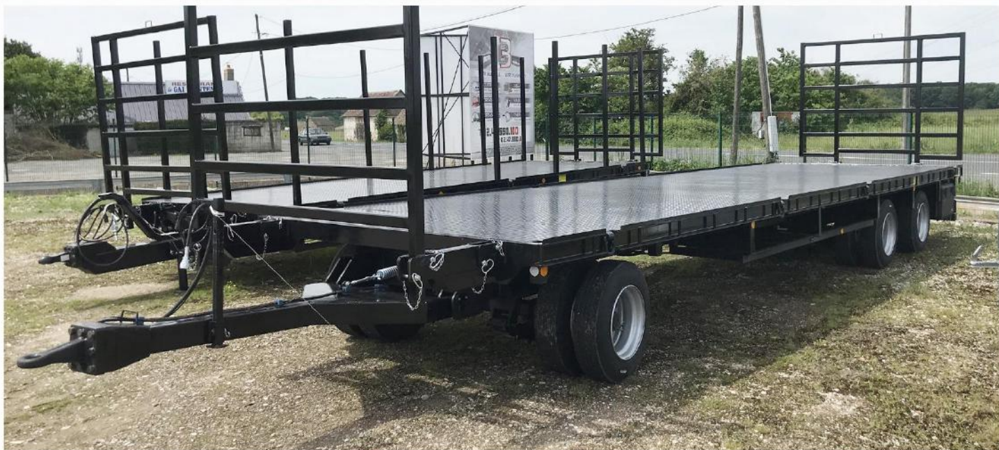
Surface utile : 11m70 x 2m54, Tourelle, RC 235/75 R17.5 Jum., Carré 20 sur plateforme, Cale-Roue...
