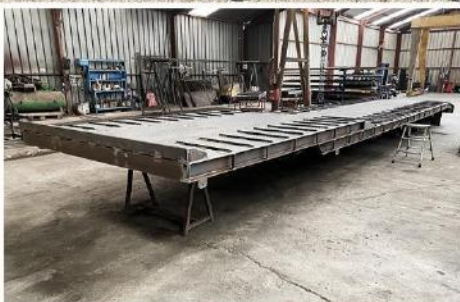
Surface utile : 11m70 x 2m54, Tourelle, RC 235/75 R17.5 Jum., Carré 20 sur plateforme, Cale-Roue...
