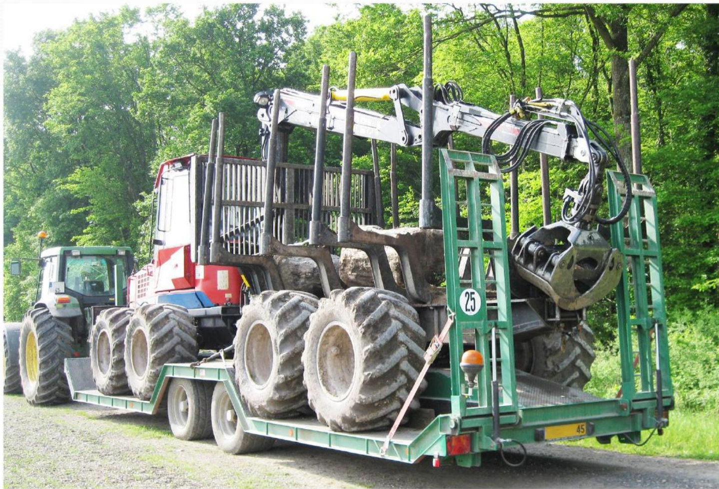
Surface utile : 10m00 x 2m54, RC 445/45 R19.5, Double ranchers avant
