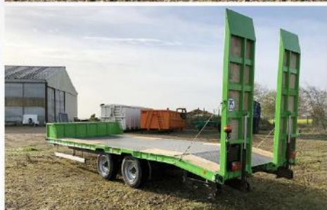
Surface utile : 7m50 x 2m54, Anneau à boulonner, RC 235/75 R17.5, Coffre sur-mesure Av., Béqu. Arr. Hydro...
