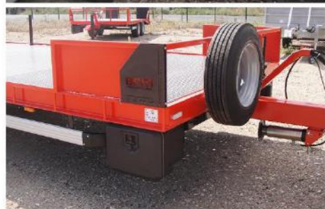
Surface utile : 8m00 x 2m54, RC 215/75 R17.5 Jum., Rampes plancher bois, Feux LED, Ranchers...
