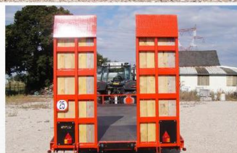
Surface utile : 8m00 x 2m54, RC 215/75 R17.5 Jum., Rampes plancher bois, Feux LED, Ranchers...
