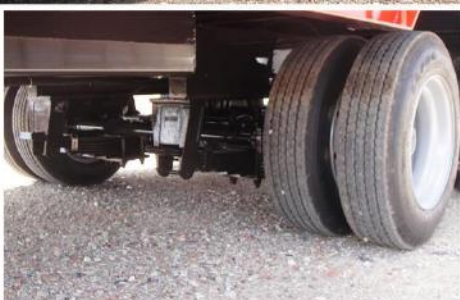
Surface utile : 8m00 x 2m54, RC 215/75 R17.5 Jum., Rampes plancher bois, Feux LED, Ranchers...
