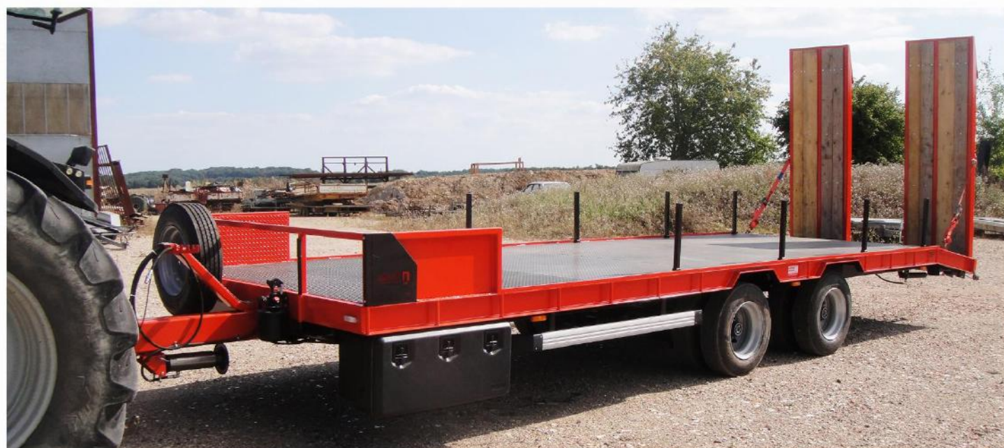
Surface utile : 8m00 x 2m54, Flèche à hauteur décalée, RC 215/75 R17.5 Jum., Face avant pleine...
