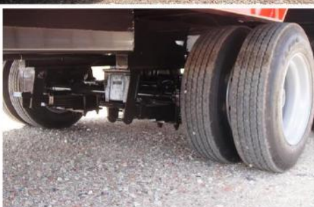
Surface utile : 8m00 x 2m54, RC 215/75 R17.5 Jum., Rampes plancher bois, Feux LED, Ranchers...
