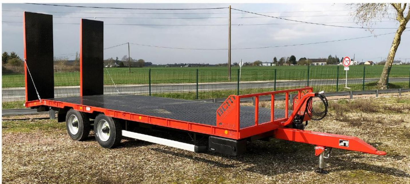
Surface utile : 7m50 x 2m54, Anneau à boulonner, RC 235/75 R17.5, Coffre sur-mesure Av., Béqu. Arr. Hydro...
