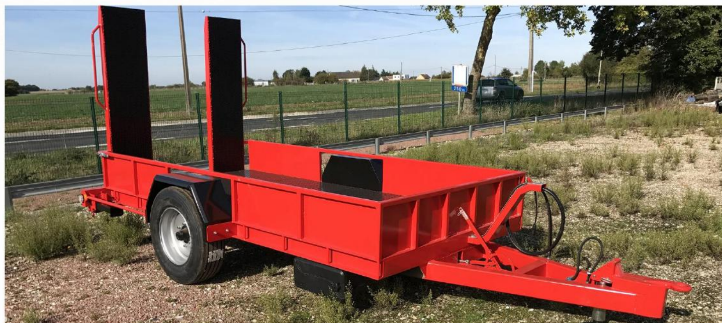
Dim. : 5m50 x 2m54, RC 235/75 R17.5 + RS, Plateau Basculant, Anneau tournant, Plate-forme Bois Intégrale...
