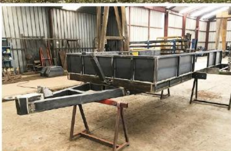
Dim. : 4m00 x 2m04, RC 285/70 R19.5, Ridelles fixes, Plancher rampes Métal déployé, Feux incorporés traverses arr...
