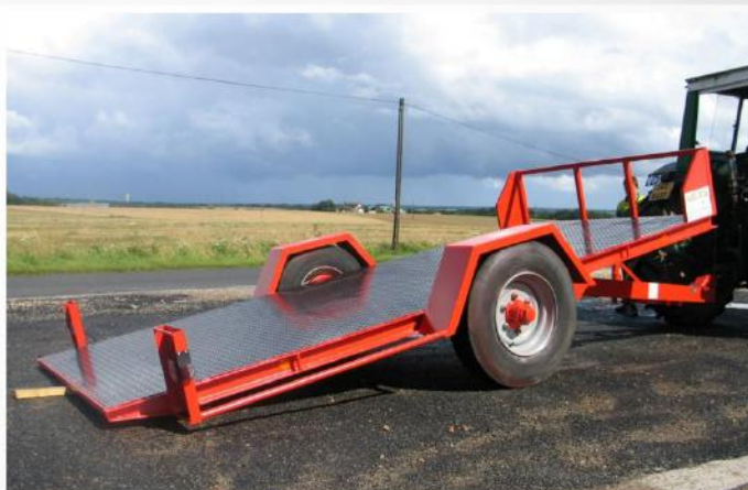
Surface utile : 4m00 x 2m04, Plateau basculant hydraulique, Essieu fixe, RC 215/75 R17.5
