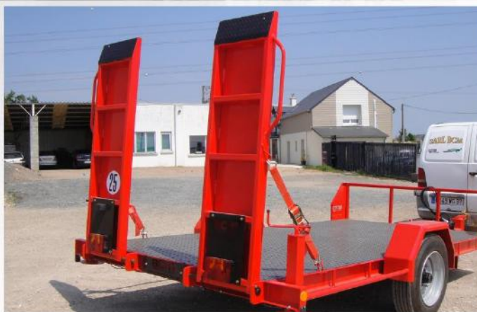
Surface utile : 4m00 x 2m04, Essieu fixe, RC 215/75 R17.5, poignées sur rampes
