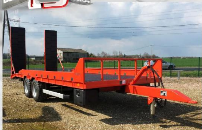
Surface utile : 7m00 x 2m54, Essieux fixes, RC 15.0-55 /17, Ridelles fixes 20cm
