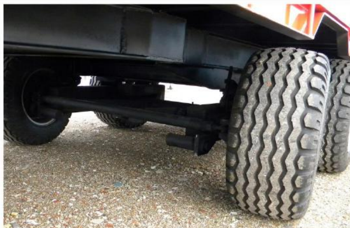
Surface utile : 7m00 x 2m54, Balancier SUIVEUR, RC 15.0-55 /17, Flèche décalée, Rampes doubles
