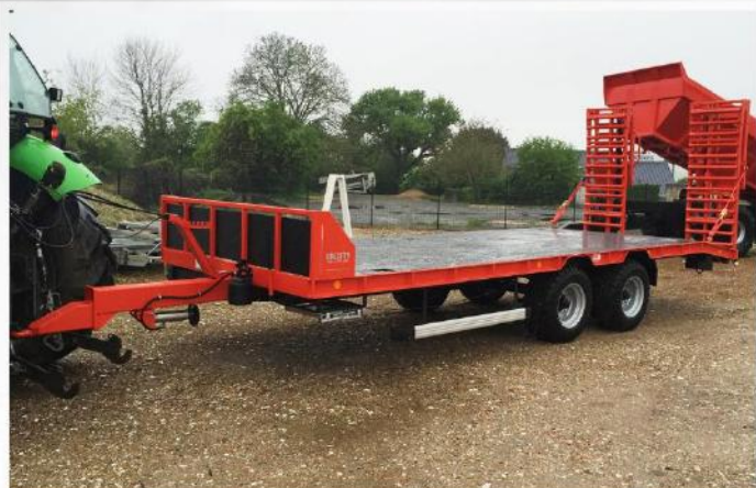
Surface utile : 7m00 x 2m54, Balancier, RC 15.0-55 /17, Flèche décalée, Rampes doubles
