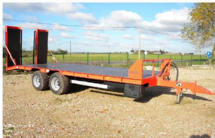
Surface utile : 7m00 x 2m54, Balancier SUIVEUR, RC 15.0-55 /17, Flèche décalée, Rampes doubles
