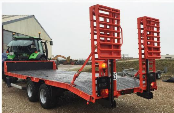
Surface utile : 7m00 x 2m54, Balancier, RC 15.0-55 /17, Flèche décalée, Rampes doubles
