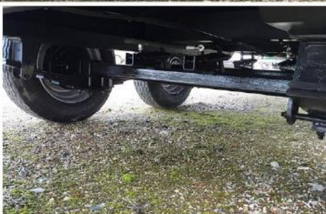
Dim. : 7m00 x 2m54, Tandem Colaert, RC 245/70 R19.5 + RS, Fer plat sur rive, Anneaux 3T, signalisation LED...
