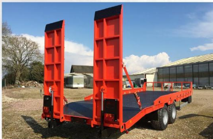
Surface utile : 7m00 x 2m54, Essieux fixes, RC 15.0-55 /17, Ridelles fixes 20cm
