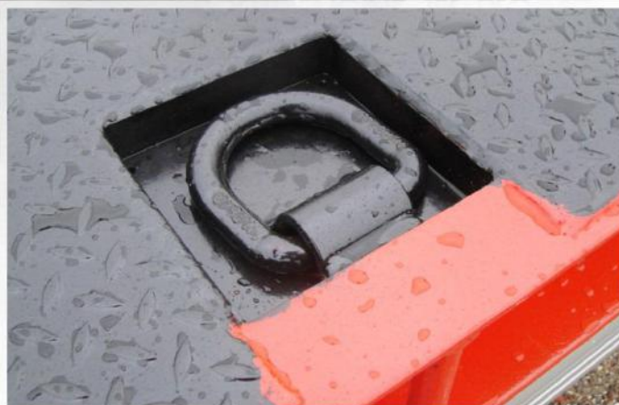
Surface utile : 5m00 x 2m54, Essieux fixes, RC 13.0-55 /17, Anneaux d'arrimages encastrés
