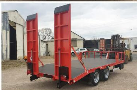
Dim. : 5m00 x 2m54, RC 13.0-55 R16, Retour grille avant (espace godets), Pompe à main...
