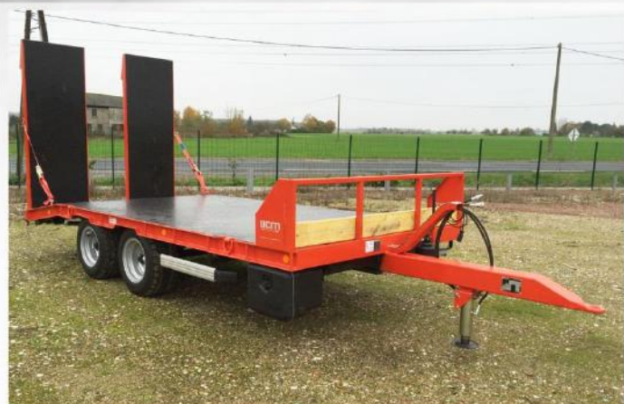
Surface utile : 5m00 x 2m30, Essieux fixes, RC 13.0-55 /16, Rampes larges (0m80), Bastaing avant
