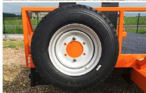
Dim. : 5m00 x 2m54, RC 215/75 R17.5 + Roue de secours & support, Plancher Rampes carré 20, Pompe à main...
