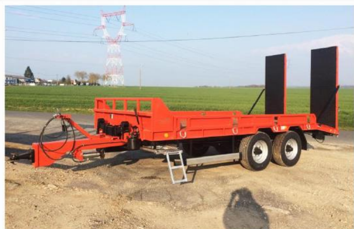
Surface utile : 5m50 x 2m54, Balancier, RC 235/75 R17.5 GoodYear, Anneau à boulonner réglable ...
