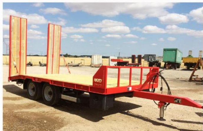
Surface utile : 5m00 x 2m54, Essieux fixes, RC 215/75 R17.5, Plate-forme Bois sapin
