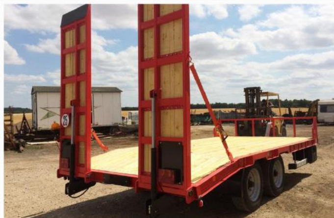
Surface utile : 5m00 x 2m54, Essieux fixes, RC 215/75 R17.5, Plate-forme Bois sapin
