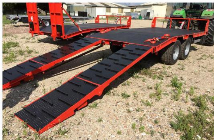
Surface utile : 5m00 x 2m54, Balancier, RC 15.0-55 /17, Rampes doubles et plancher fer + carré 20*20
