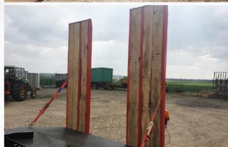
Dim. : 5m00 x 2m54, Rampes plancher Bois Guide Chenille, Béquille latérale & Pompe à main, Fer plat sur rive...
