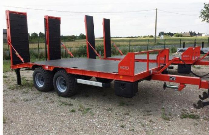
Surface utile : 5m00 x 2m54, Balancier, RC 15.0-55 /17, Rampes doubles et plancher fer + carré 20*20
