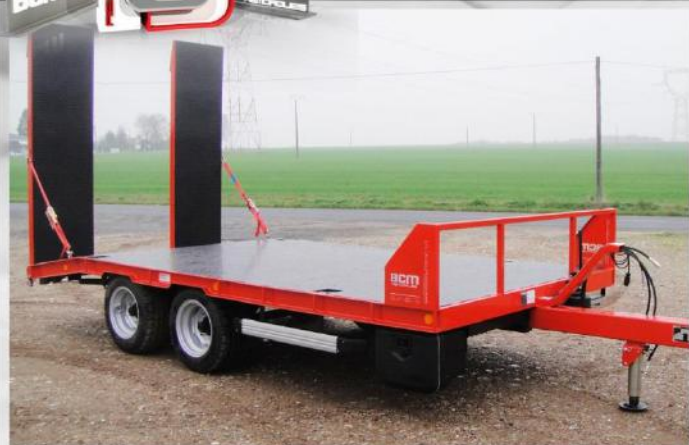
Surface utile : 5m00 x 2m54, Essieux fixes, RC 13.0-55 /17, Anneaux d'arrimages encastrés
