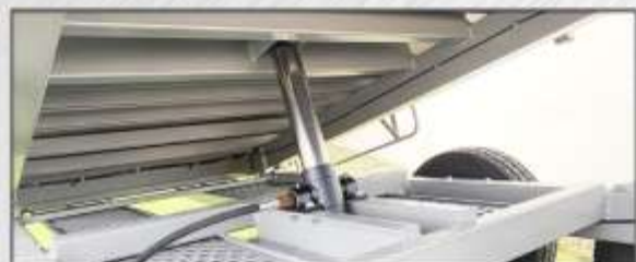
Bennage par vérin télescopique + pompe à main
