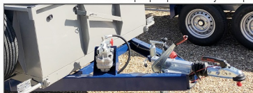
Action par pompe à main hydraulique
